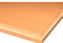
500 kPa de compresión. Panel rígido de poliestireno extruido de superficie lisa y mecanizado en todos sus cantos a media madera.
