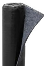
Complejo insonorizante formado por una membrana acústica a base de betún polimérico unida a un fieltro poroso a base de fibras textiles termo-fijadas con resinas especiales.
