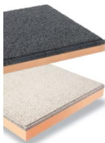
Baldosa aislante compuesta por una base de espuma de poliestireno extruido, autoprottegida en su cara superior con una capa de mortero compuesta por áridos seleccionados y aditivos especiales, y con acabado rugoso rústico.
