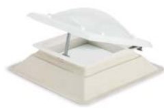
DANOVENT® MANUAL (Ventilación) Claraboya practicable con cúpula y valva de metacrilato, con zócalo de poliéster reforzado. Producto para iluminación natural y ventilación, mediante apertura manual por manivela
