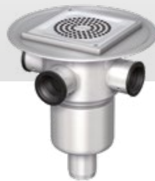
Arqueta sifónica con sumidero Câmara de Visita sifónica com sumidouro EG 150x150mm DN50 (3 entradas) Salida Vertical Saída Vertical
