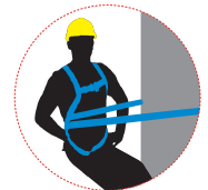
Anclaje lateral (posicionamiento)
