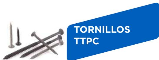
Tornillos autoroscantes con cabeza de trompeta para fijación de placa de yeso laminado sobre estructura metálica de espesor  $\leq 0,6$  mm.
