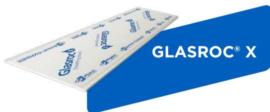
Placa de altas prestaciones, revestida y reforzada con fibra de vidrio y un tratamiento especial hidrófobo que garantiza un excelente comportamiento en ambientes de humedad muy fuerte, techos exteriores y fachadas.
