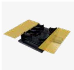
Pieza de desagüe con capacidad de descarga de 0,68 l/s y salida lateral Ø 50 mm macho. Incluye: lámina impermeabilizante **DRY50** termosellada sobre los aleros del canal y desagüe especial diseñado para este sistema que soporta altas presiones y es resistente a los productos habitualmente utilizados en piscinas.
