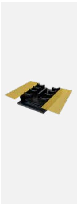
Pieza de ajuste de diferentes medidas de longitud con pendiente interna en V. Incluye: lámina impermeabilizante **DRY50** termosellada sobre los aleros del canal. Para completar la medida que precise la instalación estarán disponibles estas piezas en las siguientes medidas: 15, 25, 35, 45, 55, 65, 75 y 85 cm.
