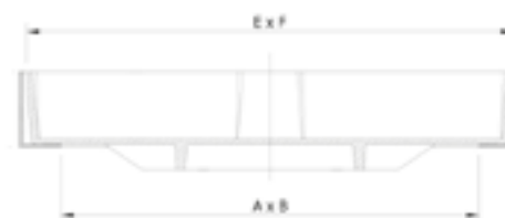
Tampa rebaixada ACO BASIC Classe D400
