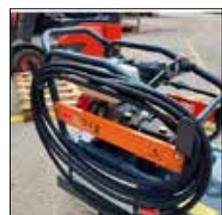
**Mecanismo** de almacenamiento de manguera y cáncamo de elevación integrados en el marco de protección
