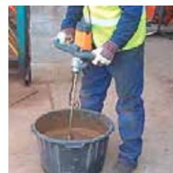
Los motores de arranque suaves proporciona a los operadores mayores niveles de control y reduce las salpicaduras.
