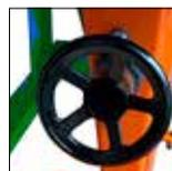
**Regulación de altura de corte mediante volante**
