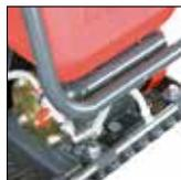
**Barra de rociado de agua** enteramente integrada en la base.
