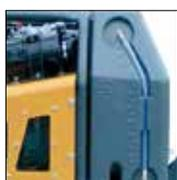
Depósito de agua de 65 litros con indicador de nivel en exterior.
