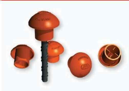
Seta protectora de 60 mm. de altura y 35 mm. de diámetro. Las setas se adaptan al extremo de varillas con diámetro comprendido entre 12 y 30 mm. gracias a las 4 aletas flexibles que lleva en su interior.
