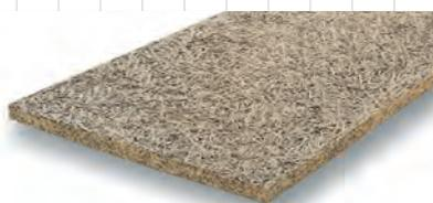
Panel de construcción de viruta gruesa de madera (abeto), aglomerado con cemento Portland gris. USOS: Eliminación de puentes térmicos en pilares, dinteles, bordones de estructuras, fondos de radiadores. Aislamiento acústico de paredes. Protección contra el fuego de techos y paredes. Encofrados.
