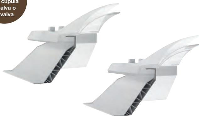
Llamamos cúpula bivalva al conjunto de dos cúpulas formando una cámara de aire intermedia. Está especialmente indicada para evitar la condensación que se produce en condiciones extremas de humedad y temperatura. Garantiza, además, un mayor aislamiento térmico, lo que nos permitirá un ahorro significativo de energía.
