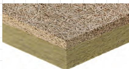
Panel térmico y acústico mineral compuesto por una capa de Celenit AB micro de 25 mm, adherida a una capa de lana de roca, de 25 o 50 mm. Usos: Falsos techos, revestimientos de paredes. Elaboración de cantos: Recto o biselado. Medida de placa exacta 120x60 cm. No permite su instalación con guía T. Los paneles se pueden atornillar directamente en el techo o la pared, o en una estructura oculta.
