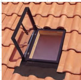
Se caracteriza por tener una apertura lateral que facilita la salida al tejado. Lleva incorporado un tapajuntas universal con babero adaptable a cualquier tejado (teja, pizarra,...). Apertura máxima 90° con bloqueo de seguridad para salir al exterior.
