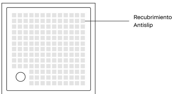
Imprimación antideslizante Antislip para platos de ducha. Esta imprimación Antislip transparente pero perceptible aumenta la adherencia dentro del plato de ducha y proporciona más seguridad durante la ducha. El acabado Antislip se aplica en fábrica bajo pedido, y resulta resistente, fácil de limpiar y además ecológico. Certificado por el TÜV, resulta apto tanto en el sector hotelero como para el uso privado.
